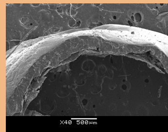
A Se observa que la adhesión de la matriz esponjosa a la película del elastómero Silastic es muy buena.
