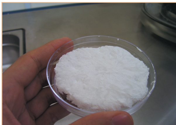
Matriz colagénica obtenida después de la liofilización
